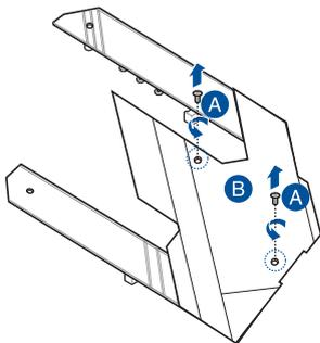
3. 移除 M.2 散热片上的固定螺丝 (A)，然后移除 M.2 散热片 (B)。
