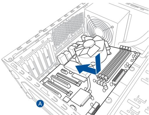
2. 移除 PCH 盖板上的固定螺丝 (A)，然后移除 PCH 盖板 (B)。
