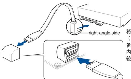
将 SATA 数据线上的直角接口端 (right angle side) 连接在 SATA 设备上，或是将直角接口端安装至主板内置的 SATA 接口，以避免造成与较大显卡的冲突。
